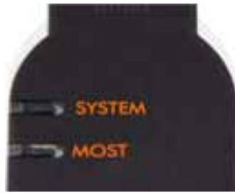
Fig. 12 Diodos luminiscentes situados en la carcasa de ICOM B
