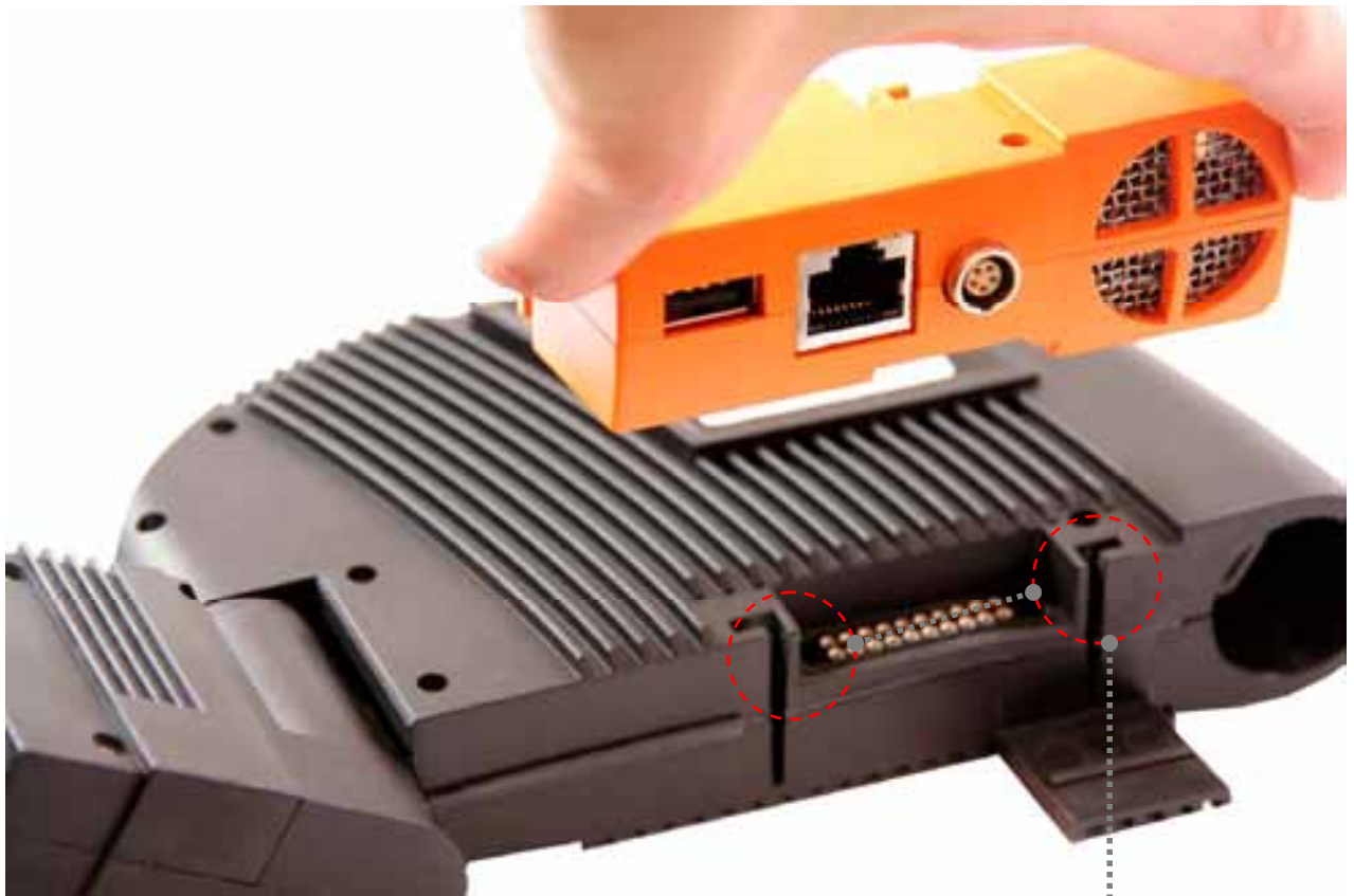
Fig. 17 Extracción/colocación de la regla de conectores
