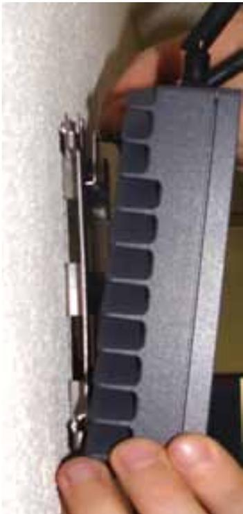
**Ilustración 4-8: Coloque primero el dispositivo desde abajo**
