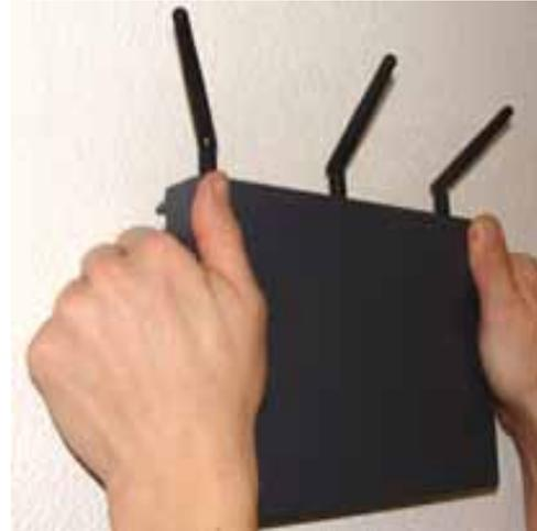
**Ilustración 4-7: Coloque el ISAP horizontalmente**
