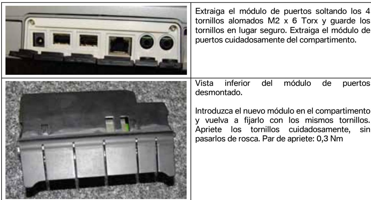
**Figura 35: Reemplazar el módulo de puertos del elemento de mando**
