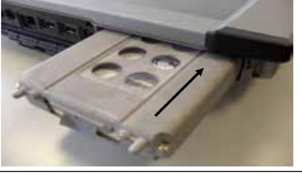
A new hard drive being inserted into the compartment. An arrow points to the top of the drive, indicating the correct orientation for the label. | <p>Introduzca el nuevo disco duro en el compartimento. La etiqueta (placa de características) debe mirar hacia arriba, en dirección a la pantalla táctil del elemento de mando.</p> |
