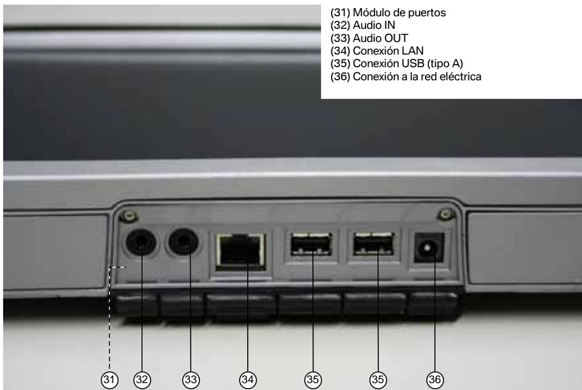
**Figura 9: Módulo de puertos del elemento de mando**
