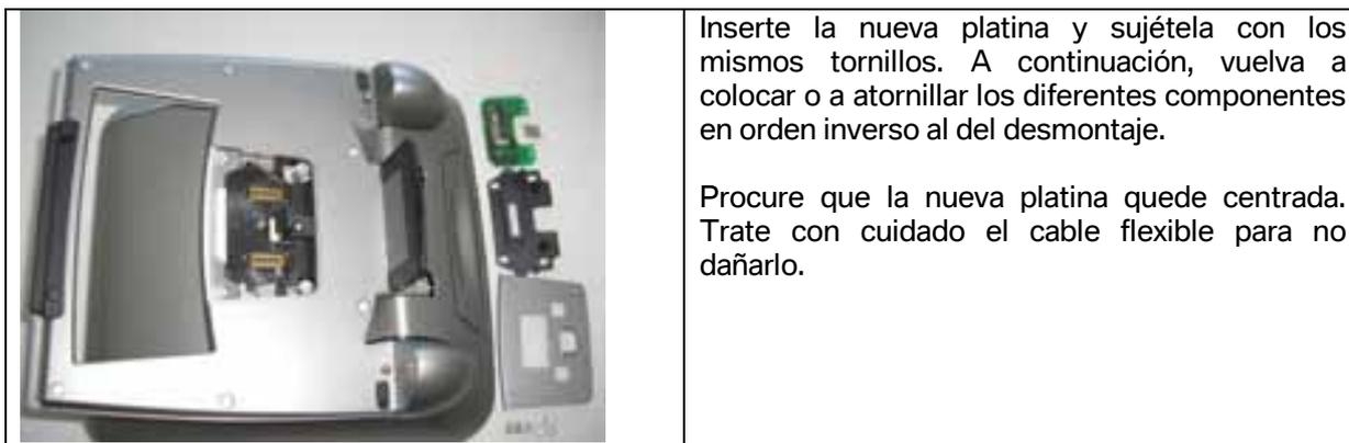
**Figura 34: Reemplazo de la interfaz de acoplamiento de la base de acoplamiento**
